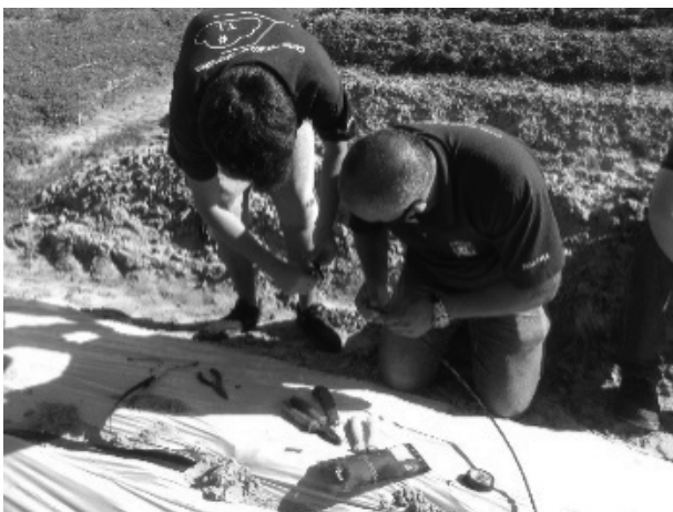
Figura 13 — Isolamento dos sensores de umidade
