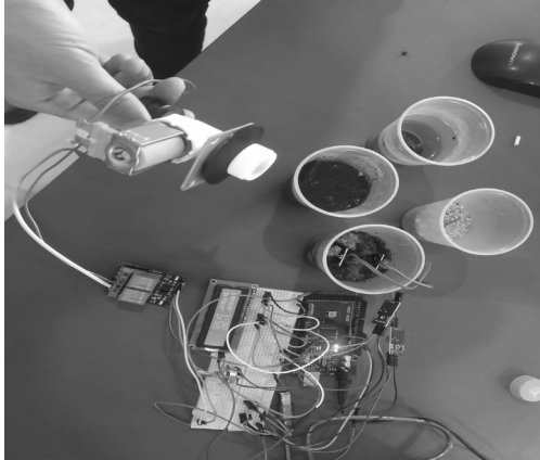
Figura 4 — Inserção da válvula solenoide ao projeto
